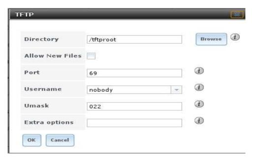
Fig. 10.19: TFTP Configuration
