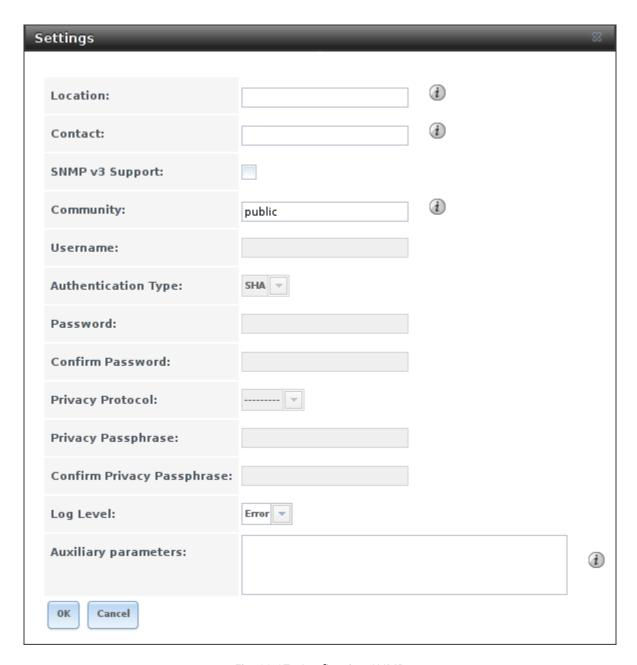
Fig. 10.17: Configuring SNMP
